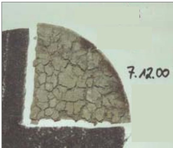
Abbildung 2-3 Rissbildung im Bentonit der Ca-GTD bei einem Wassergehalt w = 21 %
